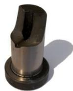
Fig. 6. Broken guide
