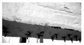
(d) Beam soffit with Ferrocement Laminate *A* after white wash
